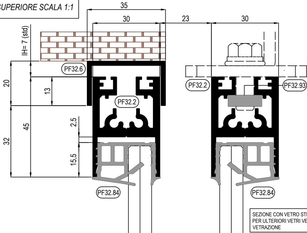
H NODO SUPERIORE VANO PASSAGGIO SCALA 1:1
