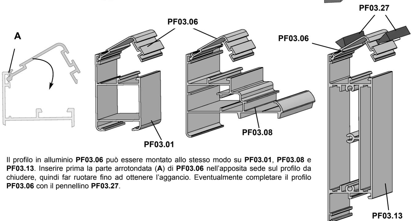
Il profilo in alluminio **PF03.06** può essere montato allo stesso modo su **PF03.01**, **PF03.08** e **PF03.13**. Inserire prima la parte arrotondata (**A**) di **PF03.06** nell'apposita sede sul profilo da chiudere, quindi far ruotare fino ad ottenere l'aggancio. Eventualmente completare il profilo **PF03.06** con il pennellino **PF03.27**.
