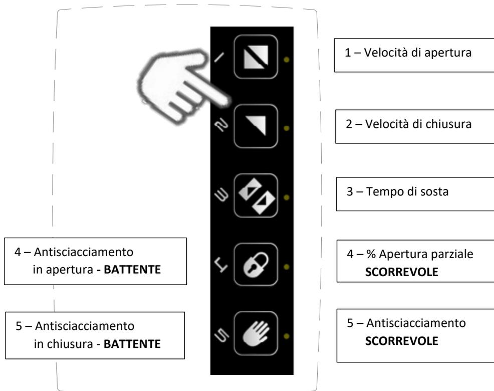
Una volta scelto il parametro da regolare i led accesi mi indicheranno il livello di regolazione (1 minimo – 5 massimo – vedi tabelle per riferimenti automazione/valori). Appoggiando il dito sul tasto, aumento (se il led non è acceso) o diminuisco (se il led è acceso) il livello di regolazione
