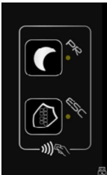
Sul display della scheda inizierà a lampeggiare la scritta A.t. mentre sul selettore inizieranno a lampeggiare i due led delle area TAG alternati.
