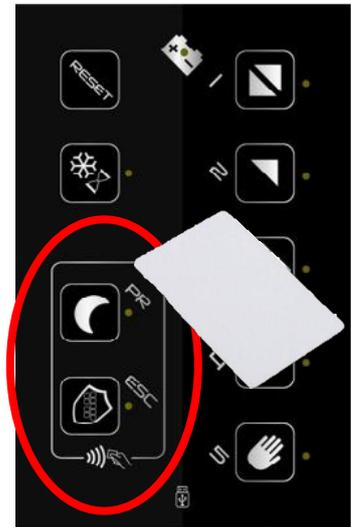
Una volta abilitati tutti i TAG per uscire dalla programmazione premere ENTER oppure ESC
